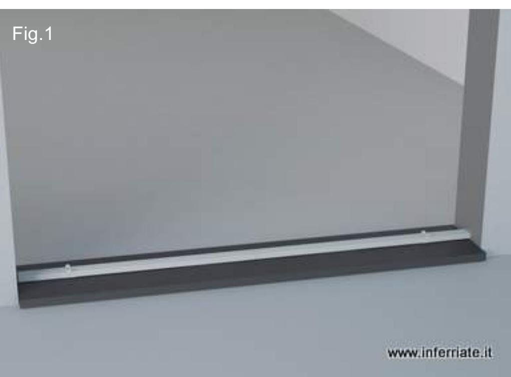
Fig. 1 Posiziona la guida inferiore sulla soglia, ti consigliamo, se possibile, di non tenerla a filo del muro esterno perché diventerebbe più difficile effettuare i fori di fissaggio con il trapano per il rischio di rottura del muro. Tieni anche in considerazione le eventuali parti che potrebbero ostacolare il funzionamento come zanzariere e soprattutto sistemi di chiusura a bandella delle persiane in legno.
