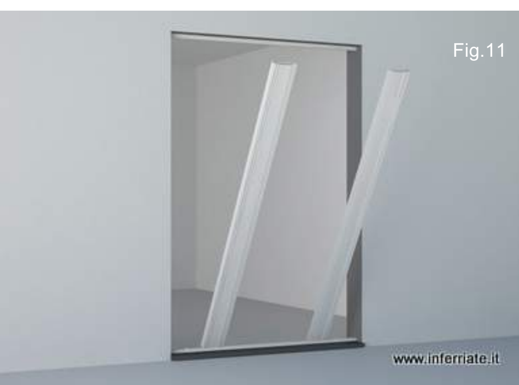
Fig. 11 Posiziona le raccolte del cancelletto nella guida inferiore come illustrato.
