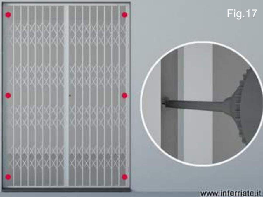
Fig. 17 Il cancelletto è ora montato e funzionante. Prova la serratura ed aggiungi del lubrificante siliconico nei punti dove fa eccessivo attrito.
