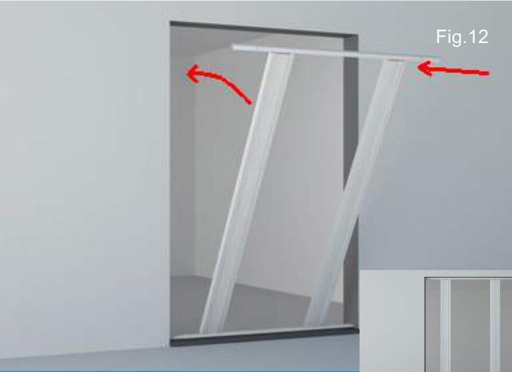
Fig. 12 Facendoti aiutare da un'altra persona, mantieni le raccolte inclinate ed infila nelle carrucole in alto la guida superiore. Una volta infilata la guida riposiziona il tutto in verticale e fissa la guida superiore sul muro.
