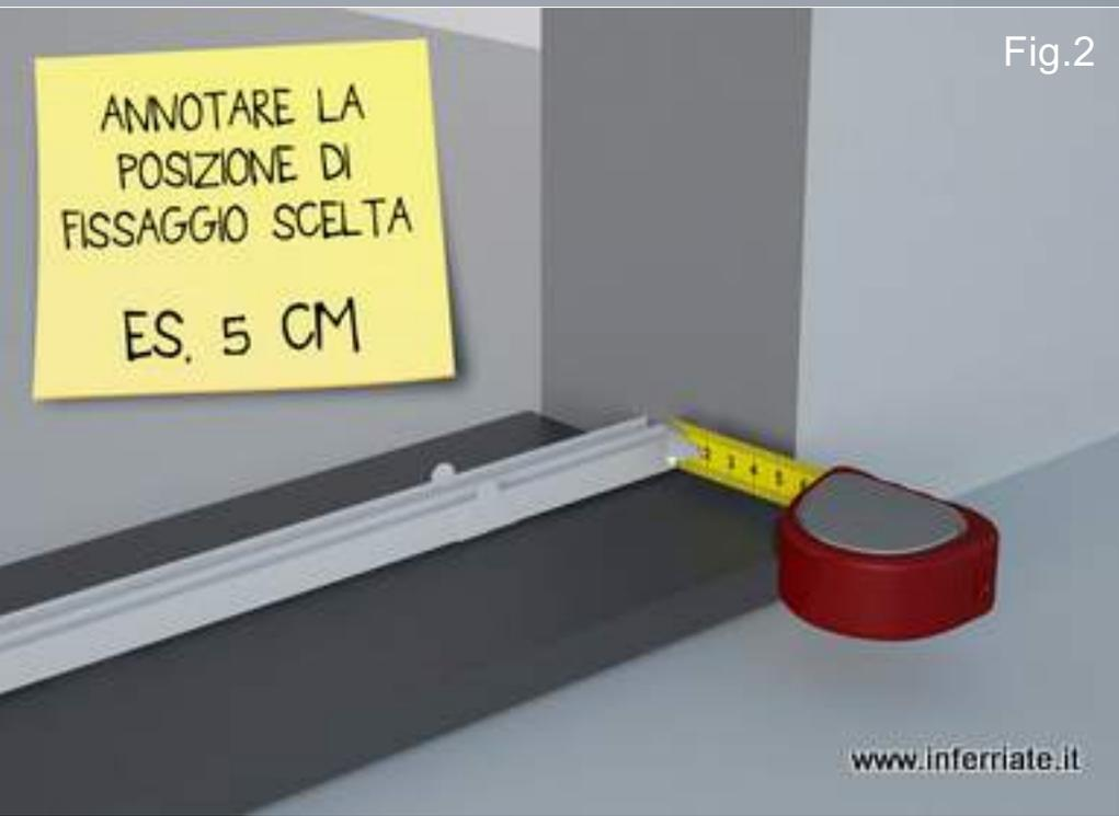
Fig. 2 Una volta deciso dove fissare la guida annota la distanza tra il filo esterno della parete e la guida stessa, questo ti servirà per accertarti di montare il cancello perfettamente in linea con la facciata esterna di casa.
